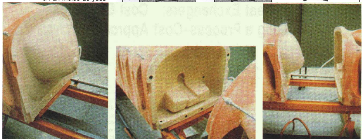
Figura 11.27. Moldeo en barbotina de piezas de cerámica. (a) Estruido del molde en un molde de yeso
